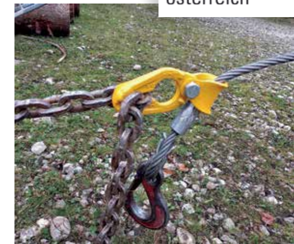
Bild 1: Eine rückwärtige Belastung von Pressklemmen führt zu einer Schwächung der Seilendverbindung und kann zu einem plötzlichen Aufreißen der Pressklemme führen.
