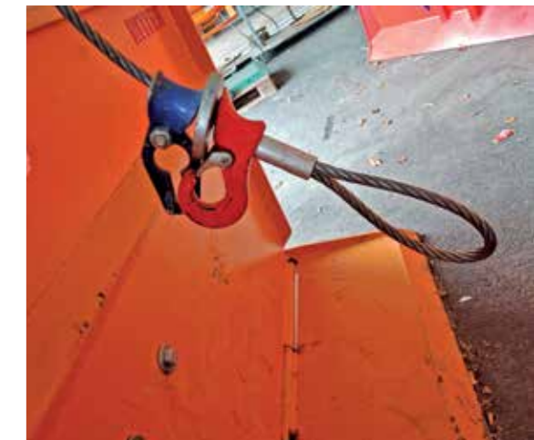
Bild 2: Wird ein Seilgleithaken in Verbindung mit einer Seilschlaufe verwendet, ist eine Verwendung von Seilgleitern möglich, ohne die Endverbindung zu schwächen.
