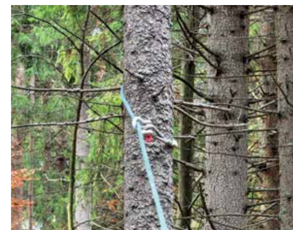
Das Hilfsseil wird über einen Ast gezogen, der Schäkel anschließend am Boden eingesetzt und die Schlinge würgend zugezogen (kein drehen).
