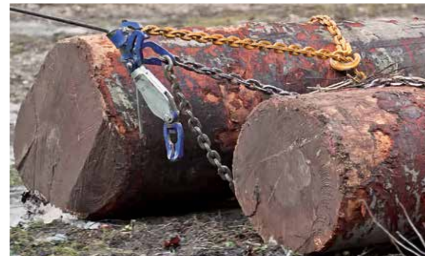
Bild 3: Die Verwendung von Seilgleitern führt zu keiner nennenswerten Schwächung von Seilschlössern. Um ein unbeabsichtigtes Lösen des Seiles im Seilschloss zu verhindern, sollte – anders als im Bild dargestellt – zuerst die Last am Seilschloss angebracht werden.
