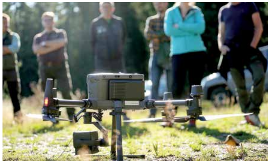
Drohnen mit Laserscanner schaffen einen genauen Überblick über Waldbestände. Foto: Tim Ritter/BOKU
