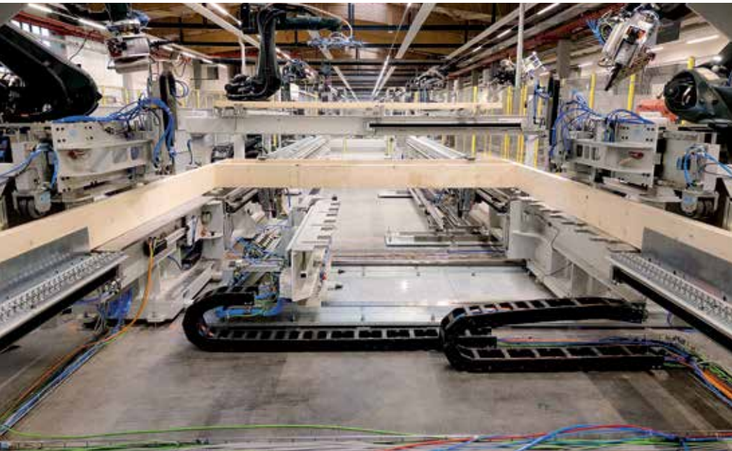
In Serie geschaltete Roboter fertigen Decken und Wände.
