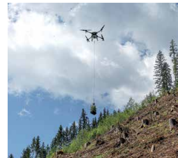
Lastendrohne transportiert Forstpflanzen in unwegsames Gelände.
