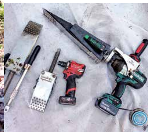
Absicherung des Einsatzortes durch Warntafeln. Innovative Technik wie mechanische Fällkeile machen die Waldarbeit leichter und vor allem sicherer.
