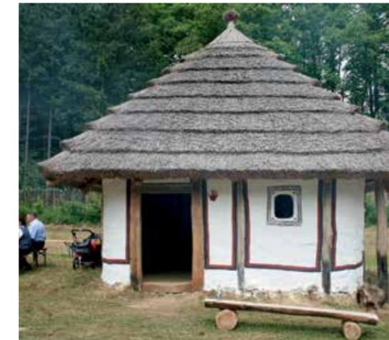
Wohnbau in Pfostenbauweise mit Wänden aus Flechtwerk und mit Lehm verputzt.
