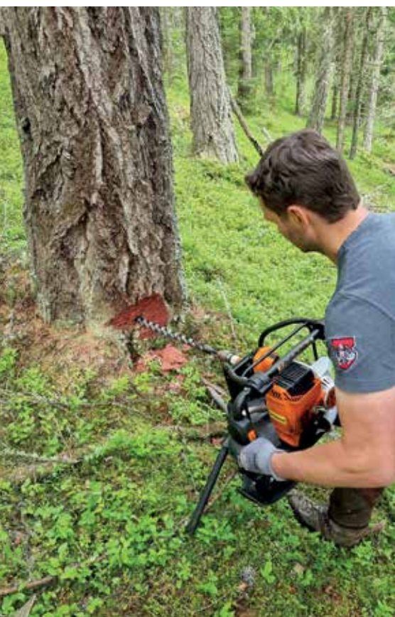
Geböhrt wird am Stammfuß, auf der Druckseite des Stammes, leicht schräg nach unten.
