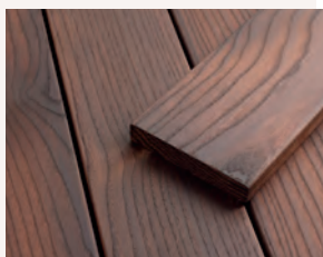
Links unbehandeltes, Rechts thermisch modifiziertes Eschenholz
