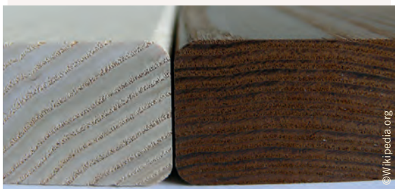
Links unbehandeltes, Rechts thermisch modifiziertes Eschenholz
