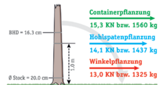
Abb. 3: Darstellung der Ergebnisse für mittlere Baumdimensionen. Die jeweilige Zugkraft greift in 1 m Höhe und im rechten Winkel zur Stammachse an. Grafik: BFW, Schnabel
