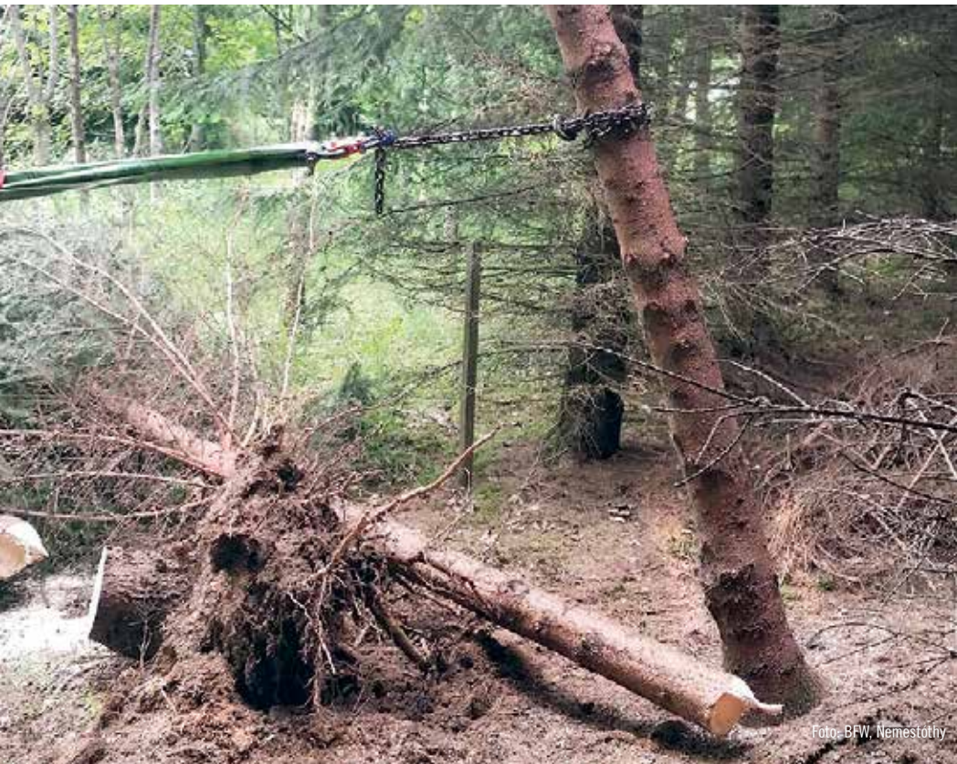
Die Versuchsbäume wurden „geköpft“ und anschließend mit einer Traktoranbauwinde umgezogen.
