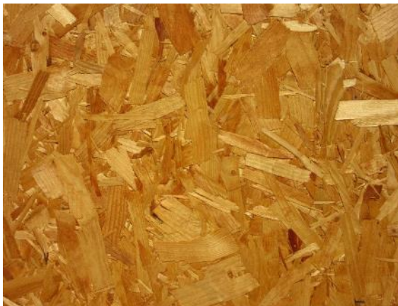
Beispiel für einen Holz-Werkstoff , der aus kleinen Holzteilen „zusammengeklebt“ wird (= OSB-Platte)
