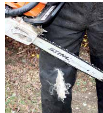
Diese Schnitthutzhose ist zu tauschen!
