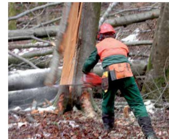
Auf den richtigen Stand kommt es an: linker Fuß vorne und ausgestreckte Arme. In dieser Haltung kann man den Körper schneller wegbewegen.
