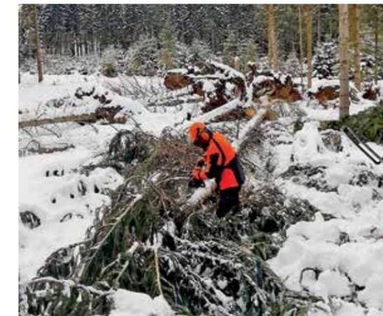
Manchmal kann es hilfreich sein, den Stamm vom Wipfel aus aufzuarbeiten, um gefährliche Spannungen zu lösen.
