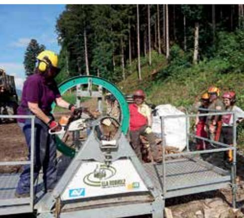
Viel Wert wird auf die richtige Pflege und Wartung der Motorsäge gelegt. Am Spannungssimulator wird gefahrlos die optimale Schnitttechnik geübt.
