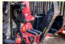
Drehkranz und Motor oder über Schwenkzylinder. Das verpflichtende Traglastdiagramm gibt Auskunft über Traglasten bei entsprechender Ausladung des Krans. Der an der Kranspitze montierte Rotator ist meist endlos drehbar und mit einer pendelnd aufgehängten Ladezange kombiniert. Ein etwaiger Tausch der Ladezange durch andere Werkzeuge erweitert den Einsatzbereich des Krananhängers.
