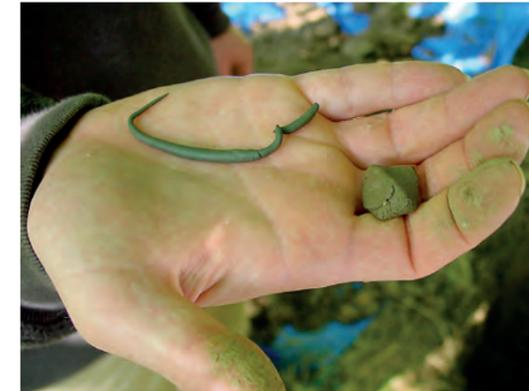
Je dünner der Boden zwischen den Fingern ausrollbar ist, desto mehr Tonanteil ist im Boden.
