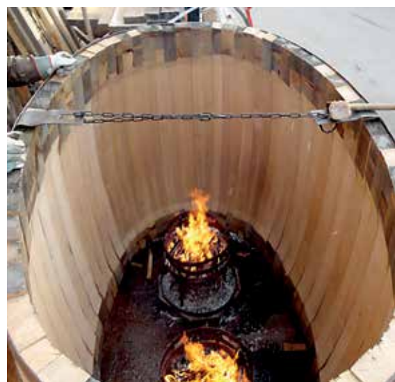
Dauer und Hitze des „Toastens“ haben entscheidende Auswirkung auf die Entfaltung der Aromen des Fasses.
