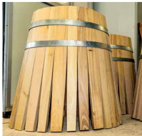
Jede „Fassdaube“ wird einzeln bearbeitet und zu einem „Reifrock“ zusammengebaut.
