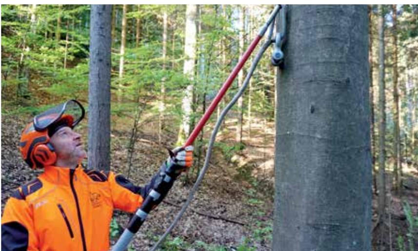
Seilunterstützte Fällung: Bei der „Königsbronner Methode“ wird das Seil mittels Teleskopstange möglichst hoch am Stamm befestigt.
