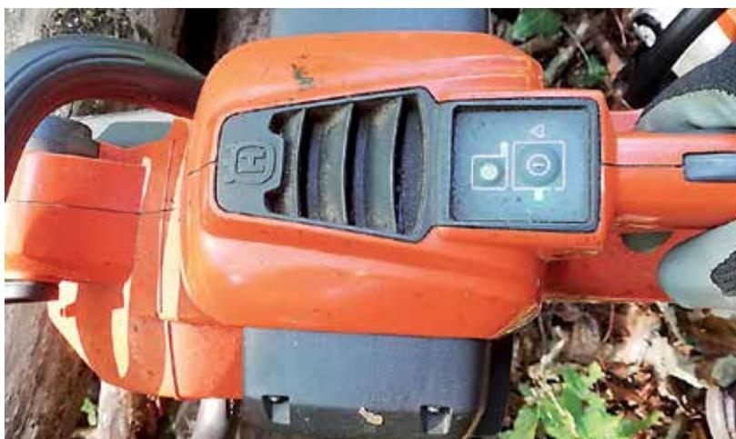
Die Akku-Säge von Husqvarna lässt sich komfortabel über einen Startknopf am hinteren Handgriff aktivieren. Über einen weiteren Knopf kann der Energiesparmodus zugeschaltet werden.
