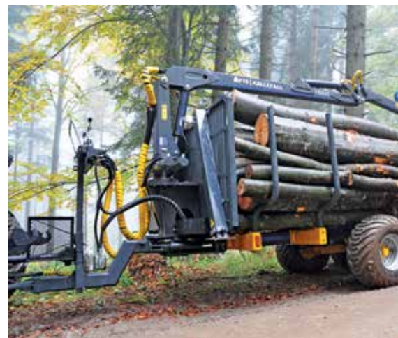
Traktor-Krananhänger mit Bedienung vom Stehpult.
