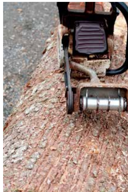
Mit der verfügbaren Borkenkäferfräse kann Rundholz effizient brutuntauglich gemacht werden.
