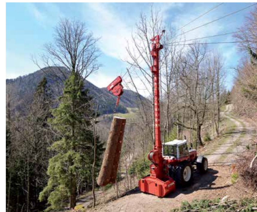
Das modular aufgebaute Seilgerät TST Junior von Tröstl ist ein kostengünstiges, leichtes (2 to, 500 m) 3-Seilgerät für den Traktor-Dreipunktbau, kann stufenweise erweitert werden.
