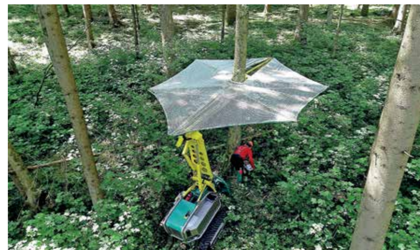
Das Pflanzel-Personen-Schutzdach wird auf der Forstraupe Moritz montiert und bietet der bedienenden Person Schutz vor herabfallenden Ästen und Zweigen.
