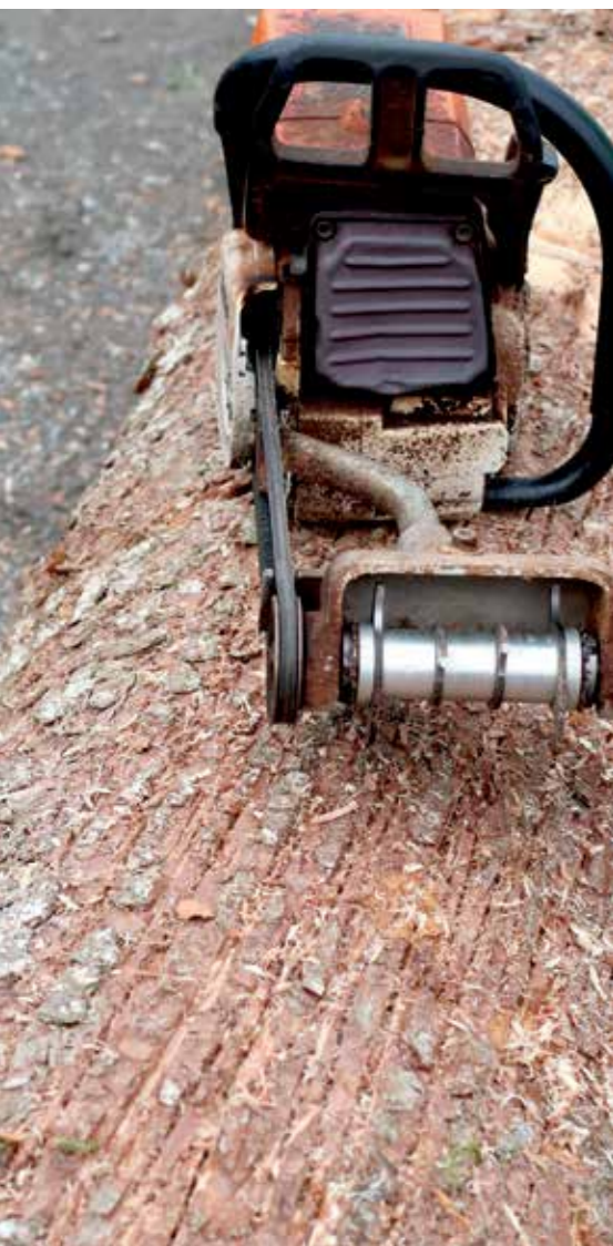
Mit der verfügbaren Borkenkäferfräse kann Rundholz sehr effizient brutuntauglich gemacht.
