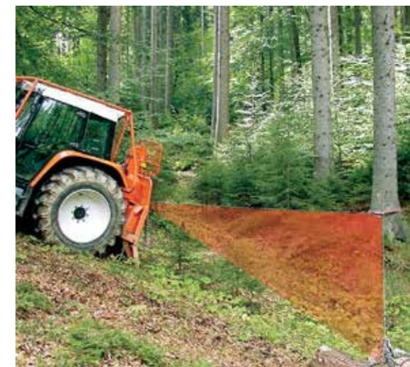
Umlenkrollen müssen immer auf die maximale Zugkraft der Seilwinde abgestimmt werden.
