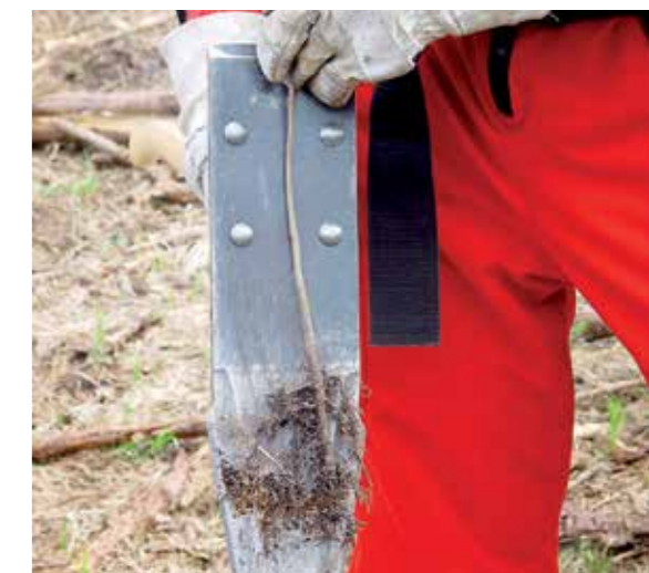
Die Hartmannhau ist für Pfahlwurzler wie Eichen ein optimales Pflanzgerät.
