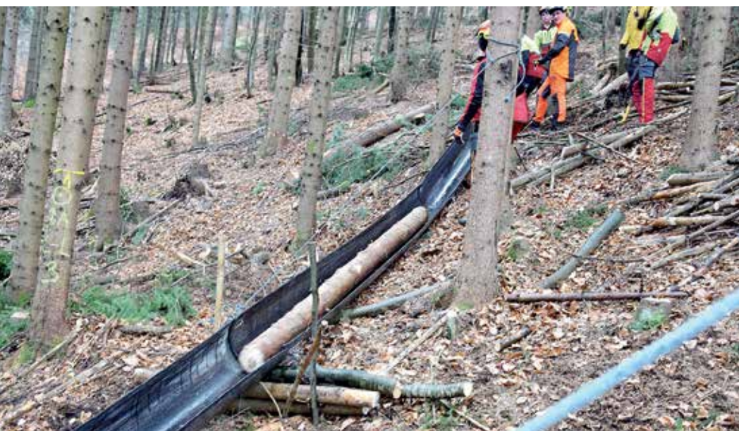
Bei Distanzen bis zu 150 Metern rechnet sich die Bringung mit der Log-Line. Fotos (2): BFW - FAST Ossiach
