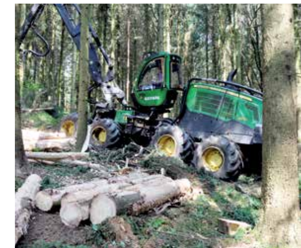
Harvester 1270G mit umgerüstetem H415 Aggregat von John Deere beim Entrinden und Ausformen von Sortimenten im Versuchsbestand.
