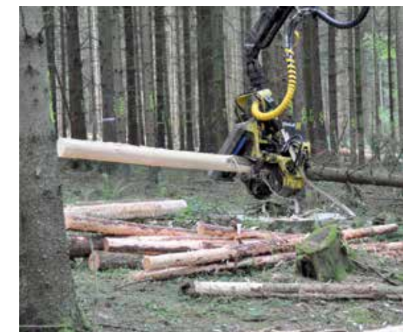
H415 Harvesteraggregat von John Deere beim Entrinden und Ausformen von Sortimenten im Versuchsbestand.
