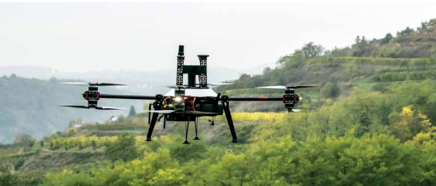
Soll ein Multicopter einen Laserscanner tragen, muss er aktuell für eine Gewichtsklasse bis zehn Kilogramm ausgelegt und bei der Austro-Control zugelassen sein. Foto: Peter Dorninger
