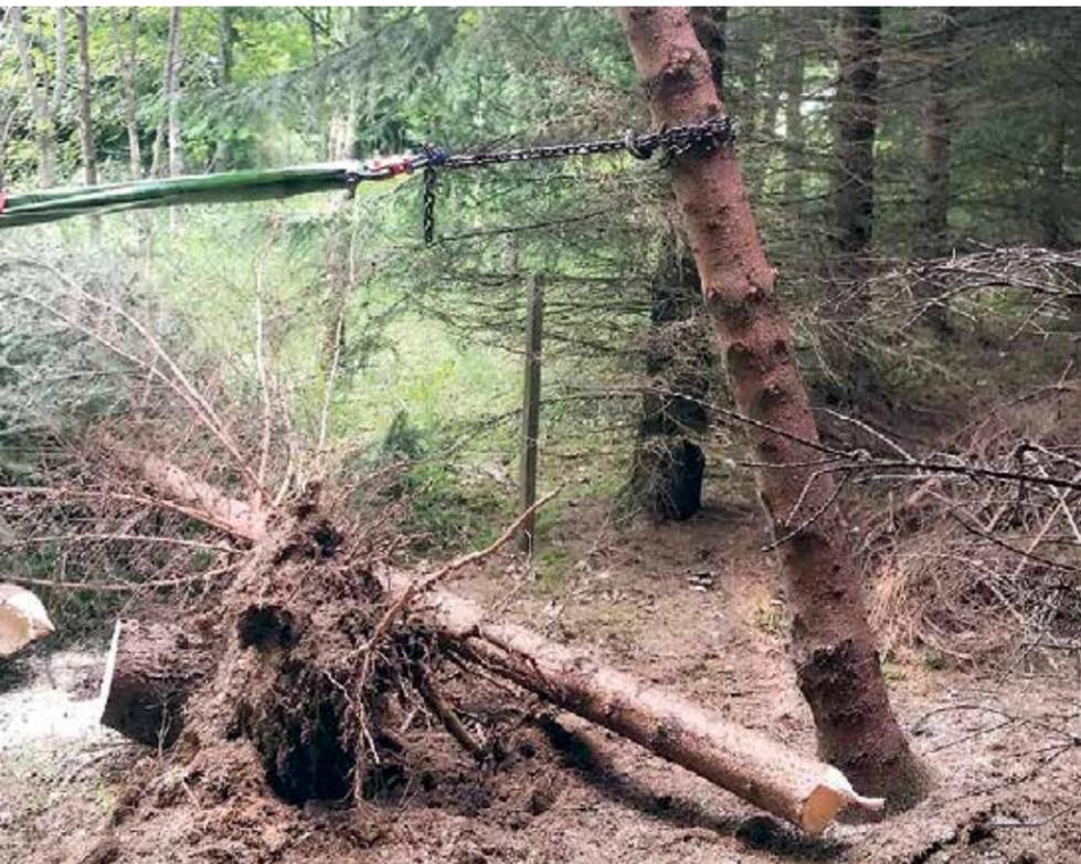
Die Versuchsbäume wurden „geköpft“ und anschließend mit einer Traktorabauwinde umgezogen. Foto: BFW, Nemesóthy
