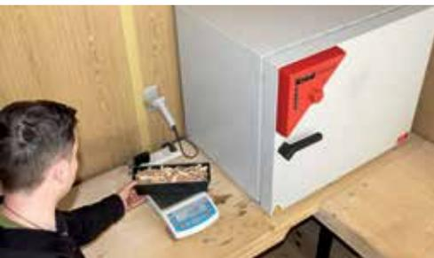
Ein Teil der Grundlage für eine korrekte Übernahme: Trockenschrank mit Waage um einerseits die Probe abzuwiegen und andererseits durch die Trocknung den Wassergehalt bestimmen zu können.
