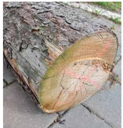
Aufgrund der Bohrgänge im Holz ist dieser überlagerte Stamm nur mehr Faserholz.
