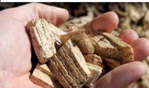
Gleichmäßig hergestelltes Qualitätshackgut aus Stammholz mit wenig Feinanteilen bietet die beste Voraussetzung für einen störungsfreien Betrieb von kleineren Heizanlagen.
