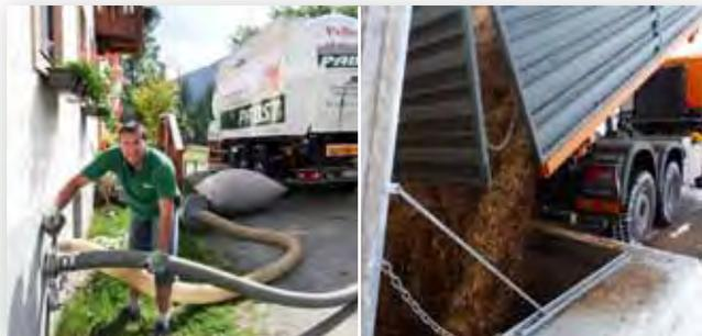
Brennstoffbelieferung bei Pellets (li.) und bei Hackschnitzeln
