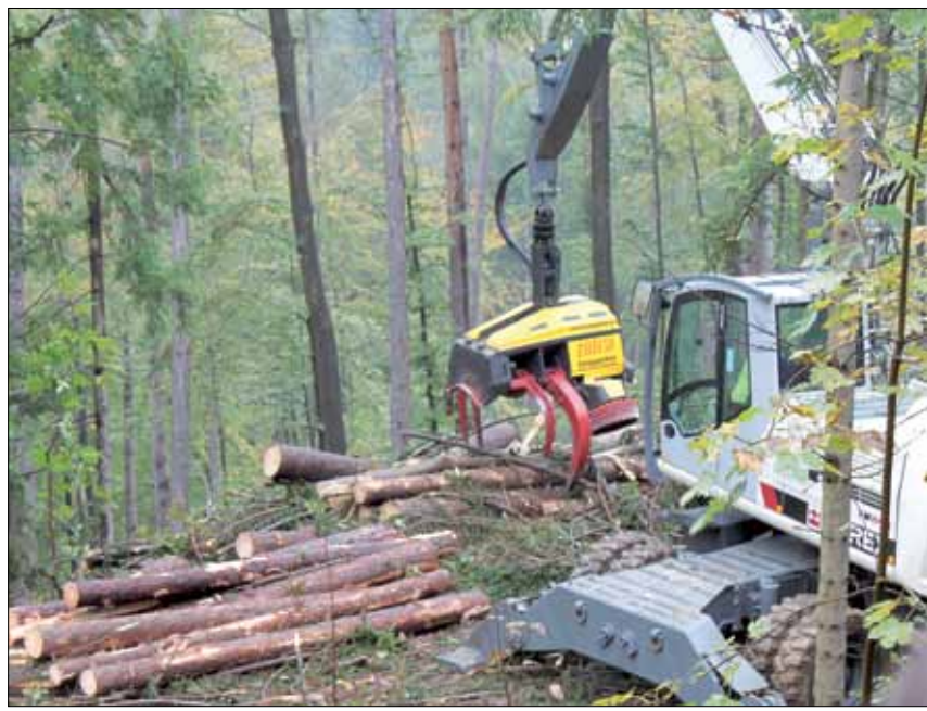
Mit dem neu entwickelte Prozessorkopf ZBH58 steht ein neues gut durchdachtes Gerät für die Aufarbeitung im Baumverfahren zur Auswahl. (Foto: Lipp)
