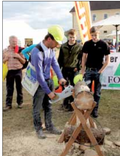
Stihl führte die erste weltweite Akkusäge vor. Sie arbeitet abgasfrei und wird gerne für Sägearbeiten in geschlossenen Räumen verwendet. (Foto: Reiterer)
