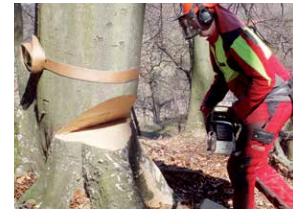
Richtiger Fällschnitt in Kombination mit einer Stammpresse verhindert ein Aufreißen des Stammes.
