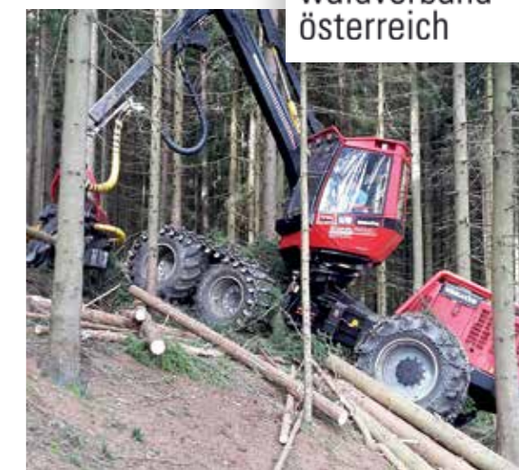
Die Auszeige der zu entnehmenden Stämme hilft dem Harvesterfahrer sich ganz auf die Fällung zu konzentrieren. Damit werden weniger Bäume des verbleibenden Bestandes beschädigt und gleichzeitig steigt die Arbeitsleistung.
