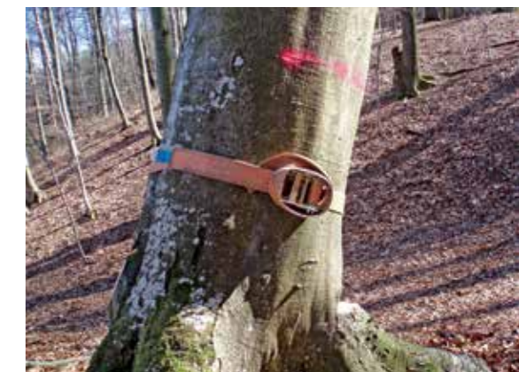
Bei Stammpressen muss man immer auf die Zugkraft achten.
