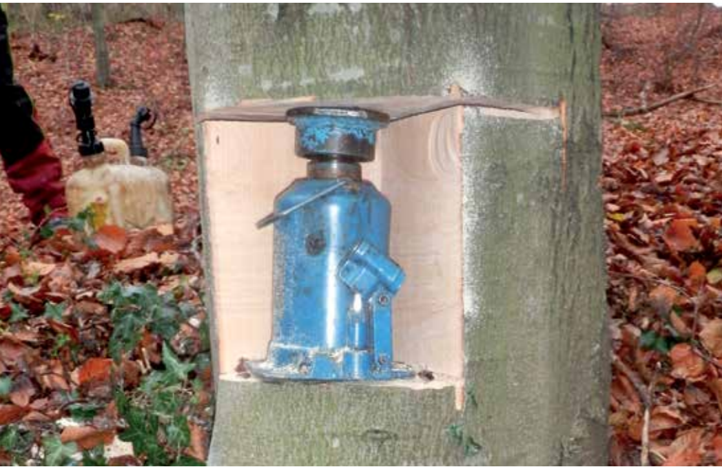
Bei Profis ist die Fällung mittels Hydraulikzylinder „Hubmandl“ beliebt.
