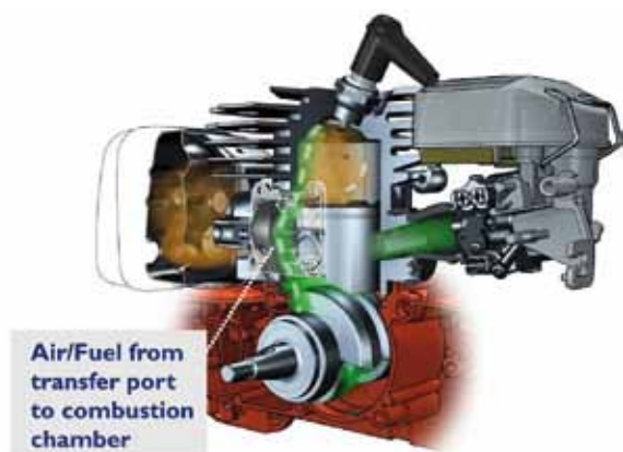
Herkömmlicher 2-Takt - Motor beim Einlassvorgang (grün = Kraftstoff - Luft - Gemisch, beige = Abgase)
