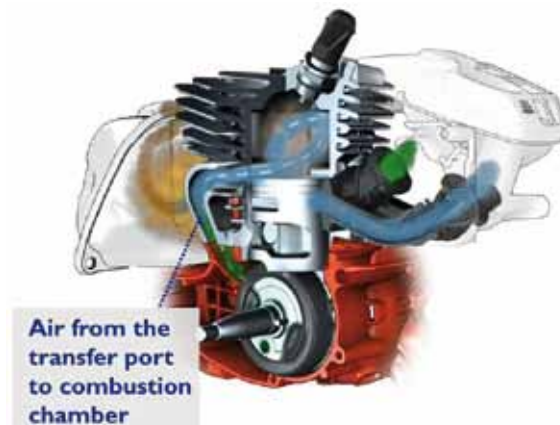
2-Takt - Motor mit Spülvorlage beim Einlassvorgang (blau=Frishluft, grün = Kraftstoff - Luft - Gemisch, beige = Abgase)
