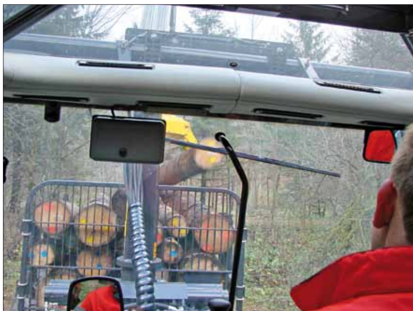
Mit Wendesitz, Rückfahreinrichtung und Armlehnen-EHC-Steuerung wird der Krananhänger schon fast ein Forwarder. (Foto: BFW, Nemestóthy)
